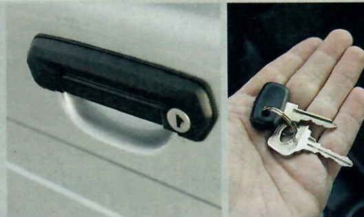
Maličké klíčky a žigulácké klyky od dveří se od doby vzniku nez- měnily. S dveřmi je potřeba pořádně bouchnout, jinak se nedovřou a nelze je zamknout.
